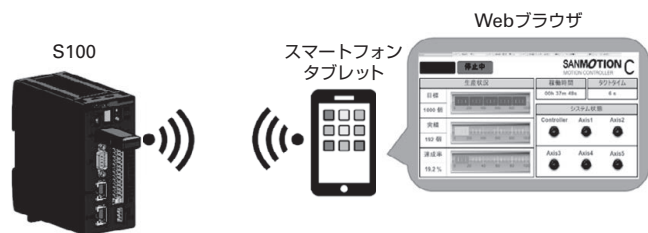
図6 生産設備の状態を見える化
