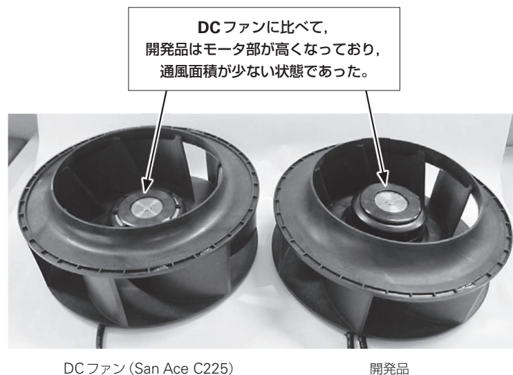
図7 開発品と DC ファンの動翼の比較
