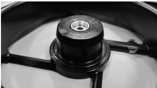
図4 活電部分のコーティング状態
