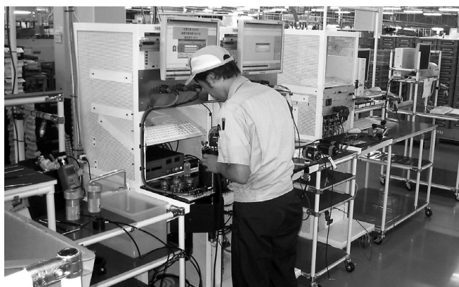
写真12 小型「Rシリーズ」センサ特性検査からラベル発行
