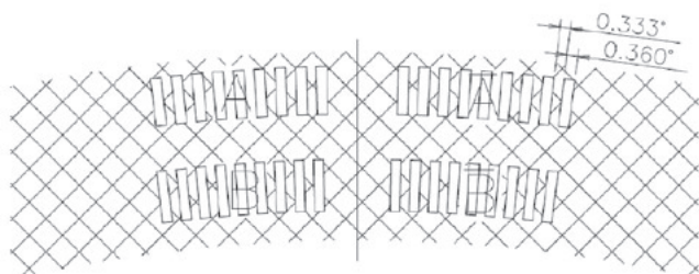
図5 通倍用固定マスクパターン
