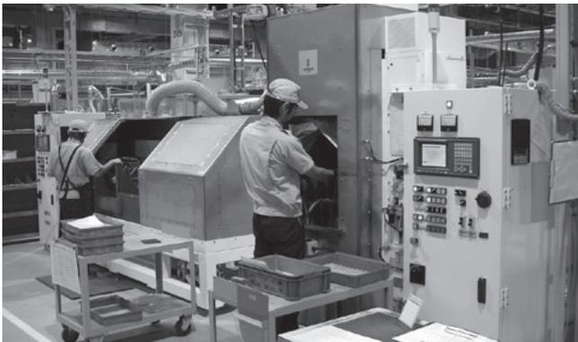
写真4 シャフト高周波熱処理装置
