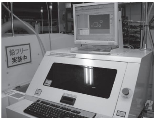
図6 クリームはんだ印刷検査装置
