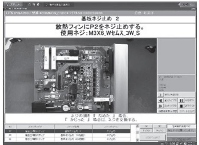
図10 電子作業指示PC画面
