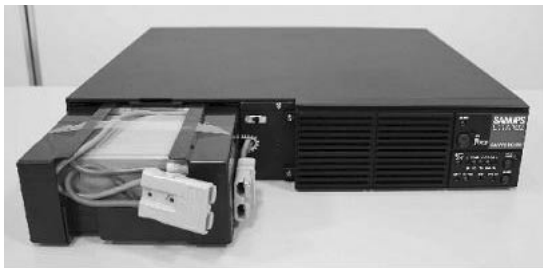
図7 バッテリー交換
