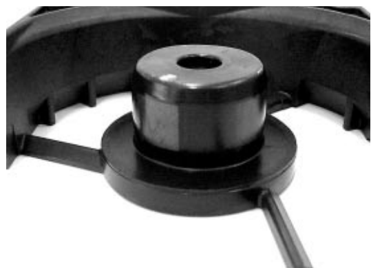
図1:活電部の樹脂封止状況
