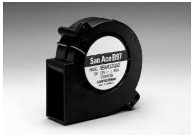
図1:97mm角33mm厚高風量遠心ファン
