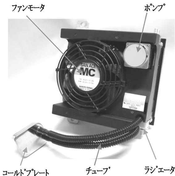
図 4 液冷システムの構成例
