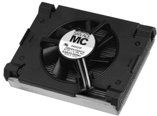
図 1 Pentium®4 1U サーバ用「サンエース MC」の外観
