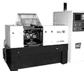
この丸ダイス転造盤は塑性加工を行なう機械で切削屑を出さない加工方法として環境保護の面としても見直されているものである。サーボアンプやI/OとはSERCOSネットワークで接続され、操作表示部であるHMI PCとはEthernetで接続されている。ネットワーク化とオープン化をAMLという言語で実現したシステムとなっている。
