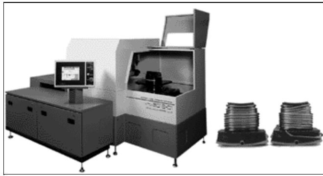
図14 巻線機概観と加工サンプル
