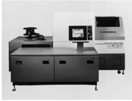
図3 ワーク回転式巻線機外観図
