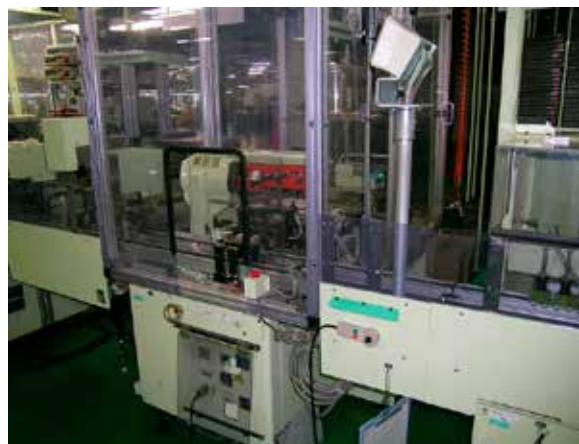
富士山工場の鉛フリー高融点はんだ設備
