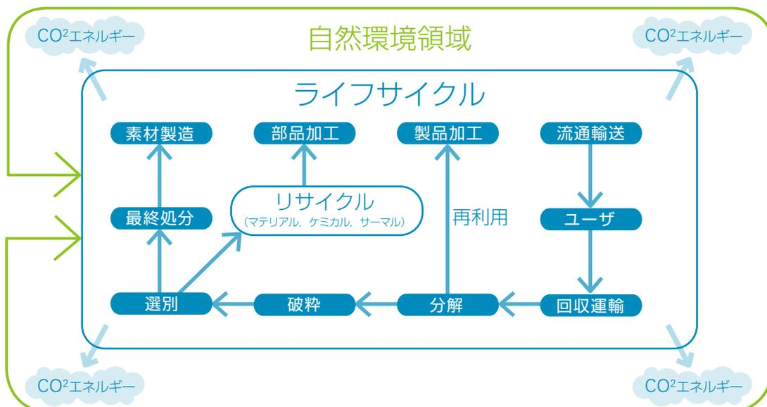
ライフサイクルの各段階で自然環境への影響（温暖化）をエネルギー消費量、CO<sub>2</sub>排出量で評価しています。
